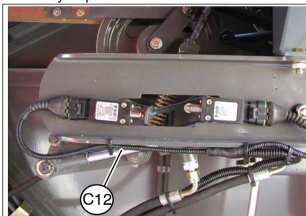
**C12.** Цилиндр включения соломорезки (дополнительное оборудование)
