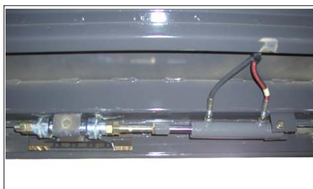
**C14.** Цилиндр регулировки стандартной поворотной опоры (входит в стандартную комплектацию моделей 5BS и 6BS, является дополнительным оборудованием для модели 6AS).
