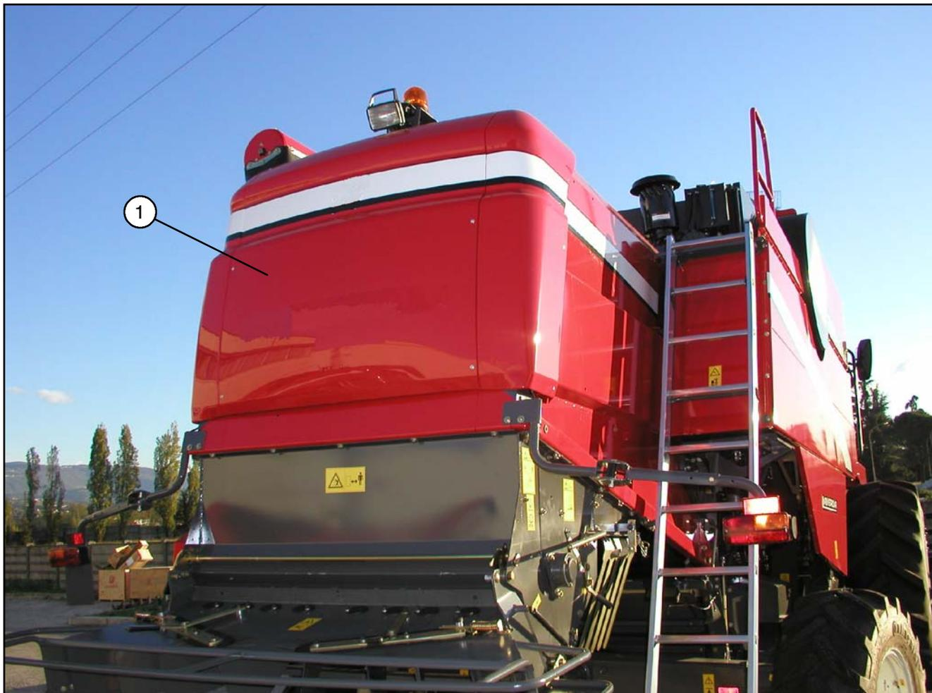
Прежде чем снимать соломотрясы, снимите наружное ограждение 1, а затем внутреннюю дверцу.
