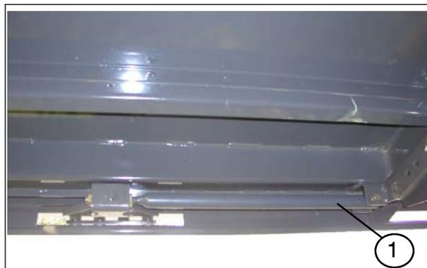
**1.** Стопорная труба поворотной опоры - является стандартной деталью на машинах без системы управления положением жатки
